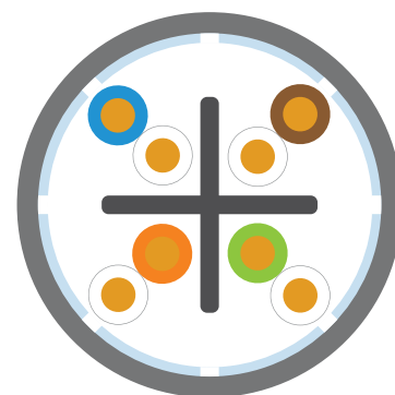
SECCIÓN DE CABLE U/UTP DE CINTA LAMINADA DISCONTINUA
